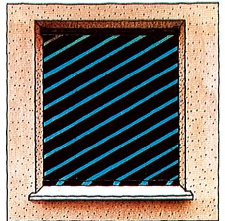
Ursache für das Beschlagen der Fenster: zu viele Pflanzen; zu dichte, abschließende Vorhänge; zu dichte, abschließende Rollos.
